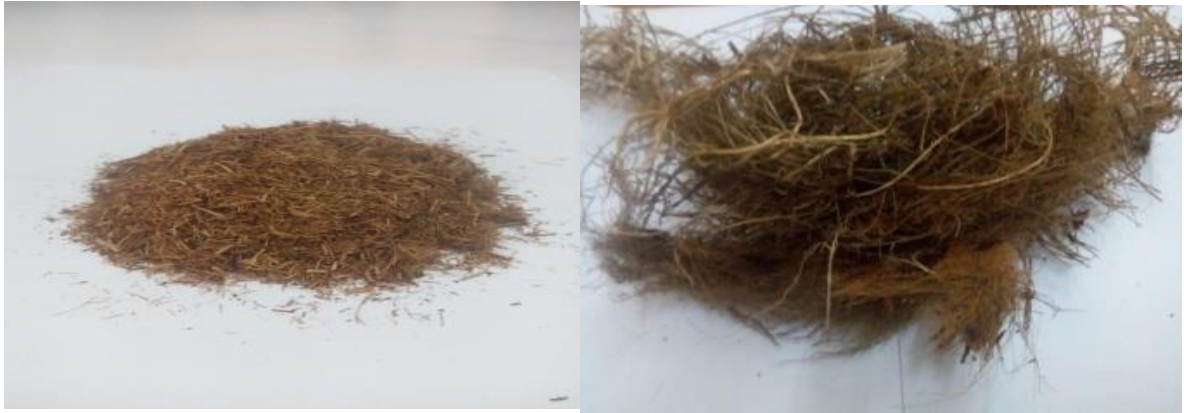
صورة توضح المادة الأولية (الليف) قبل و بعد التقطيع
