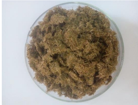
صورة للعينة المعالجة بـ NaOH عند وبعد الترشيح
